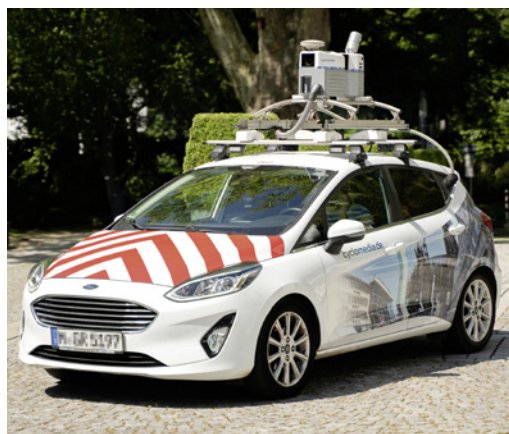
Das Kamerafahrzeug von CycloMedia. Auf dem Dach: Kamera und Laserscanner
