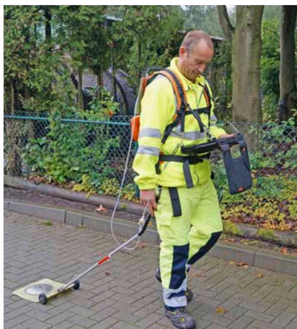
Andreas Riedinger von Dräger und Howarde Rohrnetzservice mit dem Gasspürgerät unterwegs.
